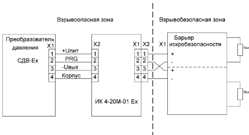
При использовании преобразователя СДВ с DIN разъемом подключение ИК 4-20M Ex производится без использования кабеля непосредственным соединением.
