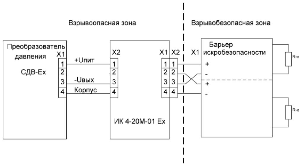
Для преобразователей с разъемом 2РМД18Б4Ш5В1В используется кабель 2PM-DIN АГБР.363.00.00
